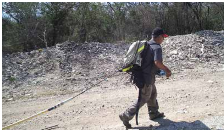
El profesor Virgilio Miniño utiliza un radar para la investigación del Lago Enriquillo. Es un sistema de penetración de radar al subsuelo (Ground penetrating radar, GPR).
